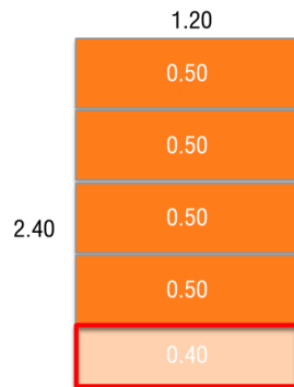
ภาพที่ 9 แสดงการแบ่งไม้อัดดำขนาด 0.50 \times 1.20 ม.
