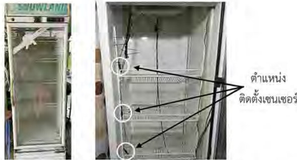
ภาพที่ 1 ตู้แช่เครื่องต้มแบบ 1 ประตู ยี่ห้อ Snowland รุ่น SNL 1000Q และตำแหน่งติดตั้งเซนเซอร์ของเครื่องวัดอุณหภูมิและความชื้นสัมพัทธ์
