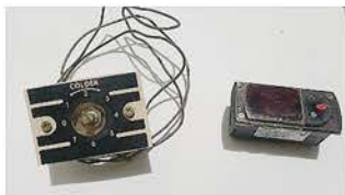
(a) เทอร์สตัดแบบหมุนและชุดควบคุมอุณหภูมิแบบดิจิตอล
