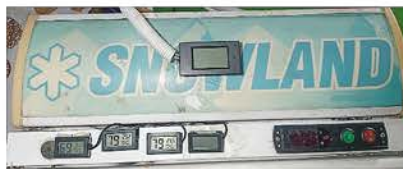
(a) เทอร์สตัดแบบหมุนและชุดควบคุมอุณหภูมิแบบดิจิตอล
