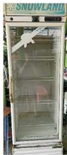
ภาพที่ 1 ตู้แช่เครื่องตีแบบ 1 ประตู ยี่ห้อ Snowland รุ่น SNL 1000Q และตำแหน่งติดตั้งเซนเซอร์ของเครื่องวัดอุณหภูมิและความชื้นสัมพัทธ์
