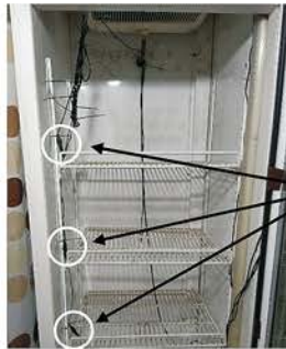
ภาพที่ 1 ตู้แช่เครื่องตีแบบ 1 ประตู ยี่ห้อ Snowland รุ่น SNL 1000Q และตำแหน่งติดตั้งเซนเซอร์ของเครื่องวัดอุณหภูมิและความชื้นสัมพัทธ์
