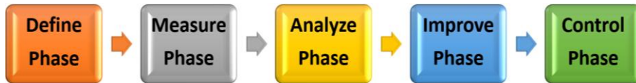
ภาพที่ 1 กระบวนการ DMAIC (Define, Measure, Analyze, Improve และ Control)
