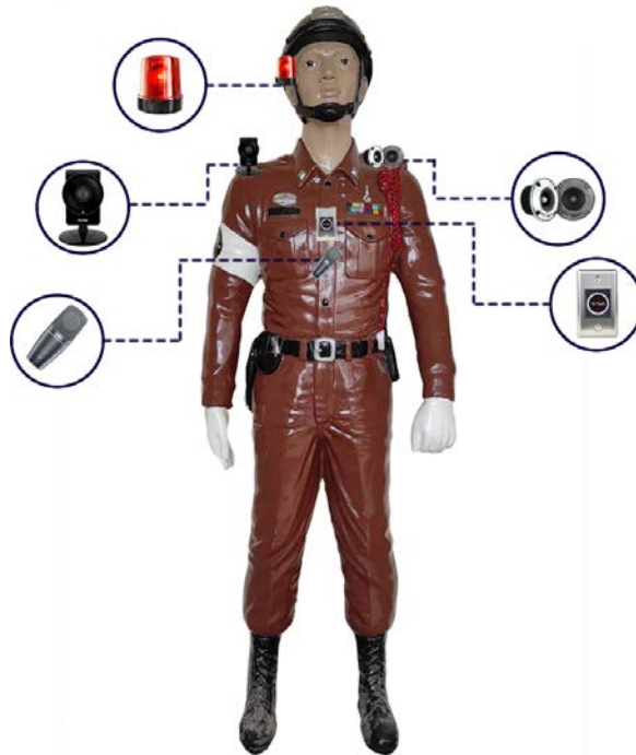
ภาพที่ 10 นำเสนอรูปแบบต้นแบบโมเดลที่ 3 รูปแบบการใช้งานหุ่นตำรวจอัจฉริยะพร้อมปุ่มกดเพื่อขอความช่วยเหลือ
