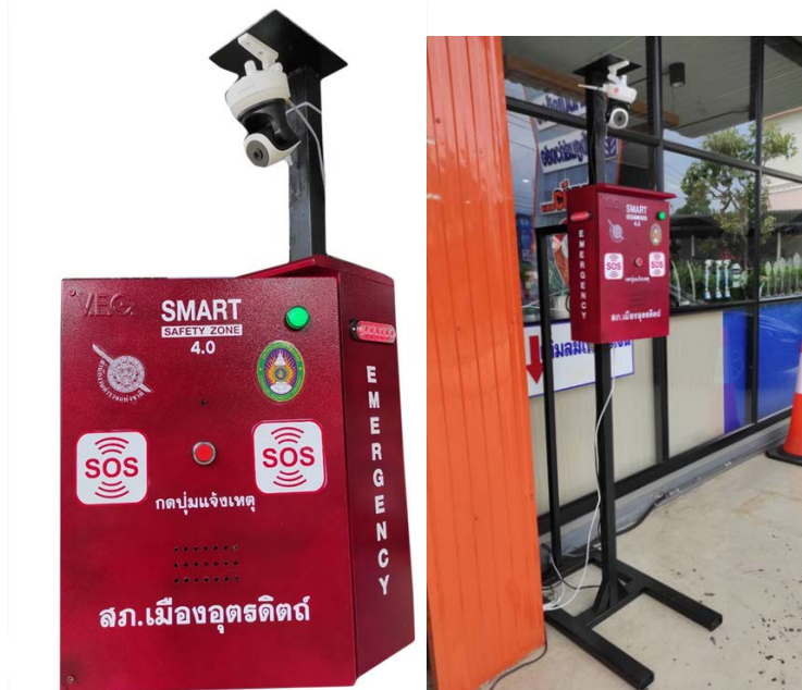
ภาพที่ 8 นำเสนอรูปแบบต้นแบบโมเดลที่ 1 รูปแบบการใช้งานปุ่มกดเพื่อขอความช่วยเหลือ
