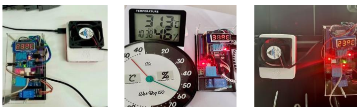
ภาพที่ 3 ภาพการประกอบอุปกรณ์ชุดควบคุมอุณหภูมิ และการทดลองความแม่นยำ
