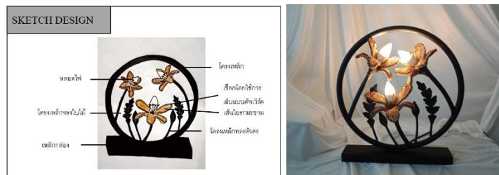
ภาพที่ 2 ภาพแสดงชุดโคมไฟที่เสร็จสมบูรณ์
