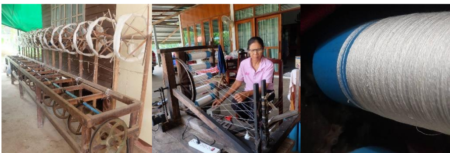
ภาพที่ 1 การผลิตเส้นด้ายผสมระหว่างเส้นใยไหมกับเส้นใยฟิลาเจน
