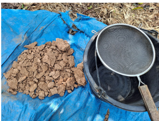
ภาพที่ 9/10 เตรียมดินจอมปลวกโดยการกรองให้ได้เนื้อละเอียดที่สุด
