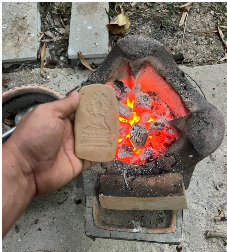
ภาพที่ 20 แม่พิมพ์ที่แห้งสนิทนำไปเผา ที่มา : นายชัยวุฒิ ปัญญาเลิศ
