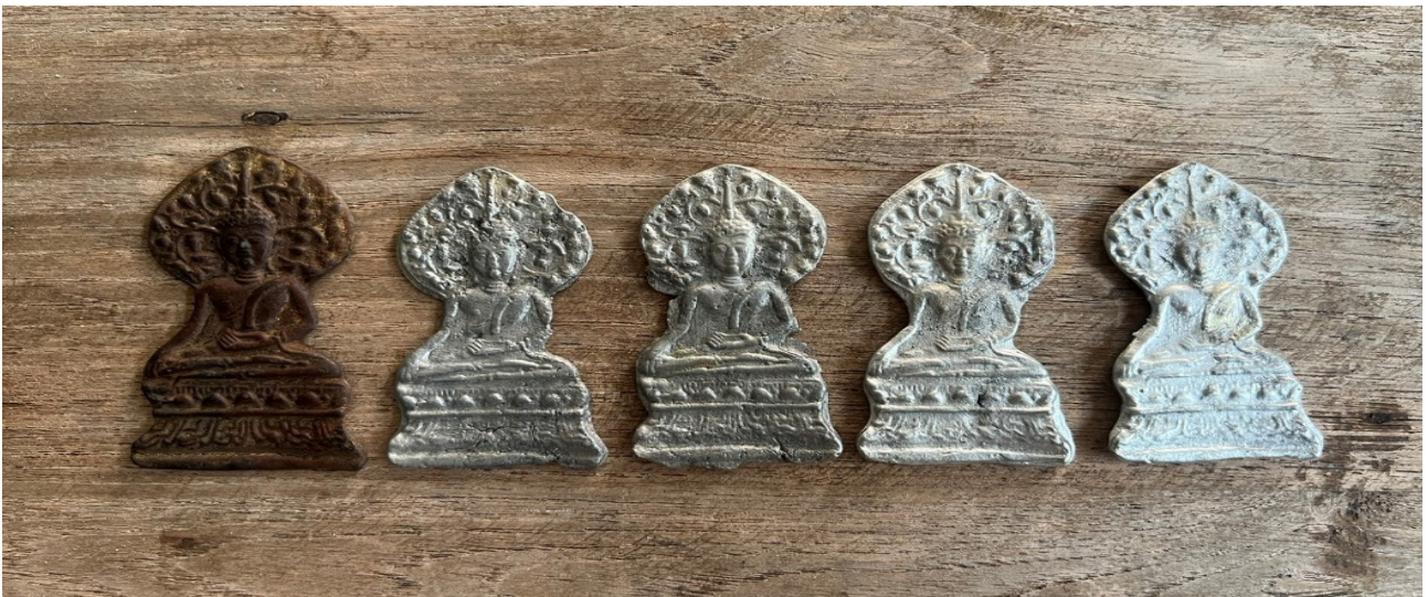
ภาพที่ 29 การเปรียบเทียบระหว่างต้นแบบและทดลองเทตะกั่ว ที่มา : นายชัยวุฒิ ปัญญาเลิศ
