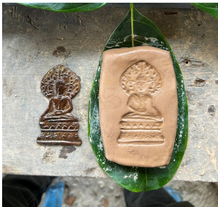
ภาพที่ 18/19 กดต้นแบบได้แม่พิมพ์ที่ต้องการและสมบูรณ์แบบ ที่มา : นายชัยวุฒิ ปัญญาเลิศ
