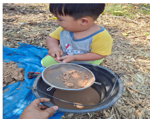
ภาพที่ 9/10 เตรียมดินจอมปลวกโดยการกรองให้ได้เนื้อละเอียดที่สุด
