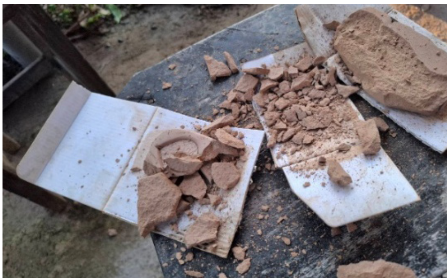
ภาพที่ 21 ทดลองเผาแม่พิมพ์ในอุณหภูมิที่สูงปรากฏว่าทำให้แม่พิมพ์เกิดระเบิดแตกหัก ที่มา : นายชัยวุฒิ ปัญญาเลิศ
