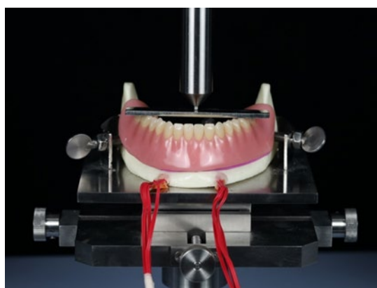
ภาพที่ 3 การทดสอบบนเครื่องทดสอบแรงอเนกประสงค์ภายใต้การลงแรงด้านท้ายของฟันเทียม
