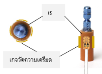
ภาพที่ 2 แสดงการเคลือบเรซินรอบรากเทียม และตำแหน่งของเกจวัดความเครียด
