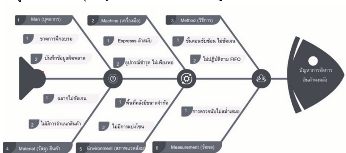
ภาพที่ 3 แผนภูมิแก๊งปลาแสดงสาเหตุของปัญหาการจัดการสินค้าคงคลัง
