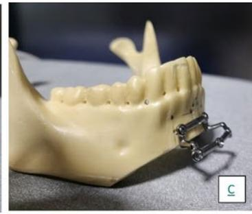
ภาพที่ 3 แผ่นโลหะตามกระดูกคางไทเทเนียมภายหลังการติดตั้งด้วยเครื่องทดสอบแรงอเนกประสงค์ แบบสำเร็จรูป แบบเฉพาะบุคคลรูปแบบ 4 สกรู และ 5 สกรู
