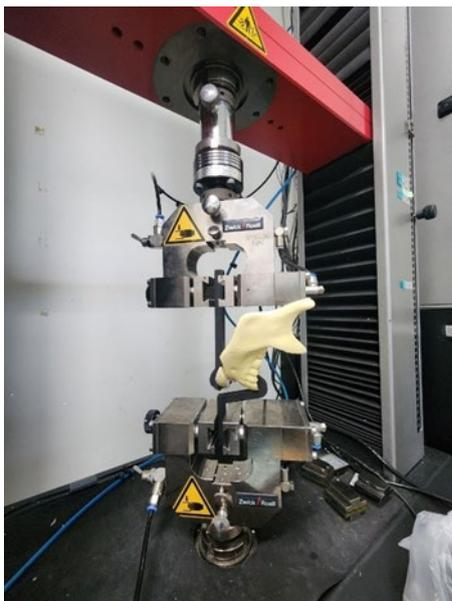
ภาพที่ 4 การจัดทิศทางของขากรรไกรสังเคราะห์บนเครื่องทดสอบแรงอเนกประสงค์
