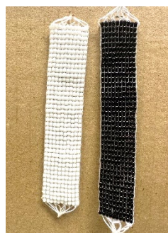
1.วัสดุเส้นยืนด้ายเส้นทอด้าย 2.วัสดุเส้นยืนด้ายเส้นทอไหม 3.วัสดุเส้นยืนด้ายเส้นทอเอ็น 4.วัสดุเส้นยืนด้ายเส้นทอลวด ภาพที่ 2 ภาพการวิเคราะห์วัสดุเส้นยืนด้ายและเส้นทอด้าย ไหม เอ็น ลวด
