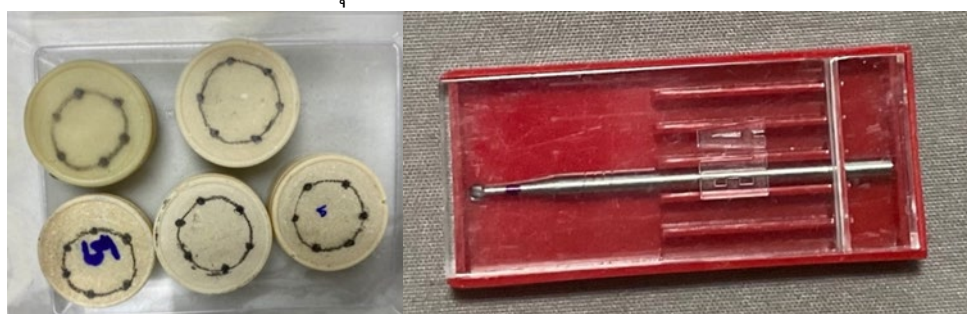
ภาพที่ 2 แสดงเส้นกำหนดขอบเขตสำหรับการทดสอบวัสดุและแสดงหัวกรอที่ใช้ในการทดสอบ
