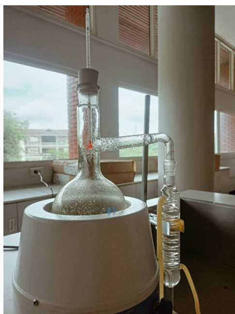
ภาพที่ 2 วิธีการกลั่นด้วยน้ำของการสกัดน้ำมันหอมระเหยจากกัญชา
