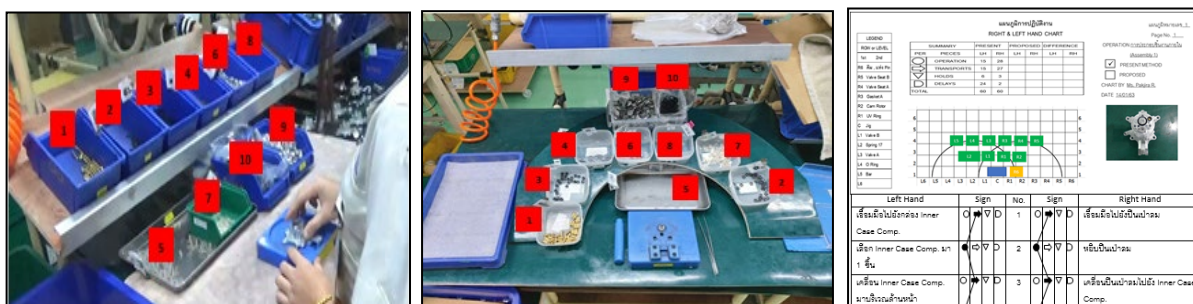
ภาพที่ 9, 10, 11 การจัดวางกล่อง(ก่อนการปรับปรุง), พื้นที่วางกล่อง (หลังการปรับปรุง), ศึกษาการใช้มือซ้ายและขวา
