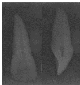
รูปที่ 2 แสดงภาพรังสีฟันโมเดล 3 มิติซี่ฟันหน้าบน ที่พิมพ์ด้วยเรซินชนิด NextDent C&B MFH (Micro Filled Hybrid)
